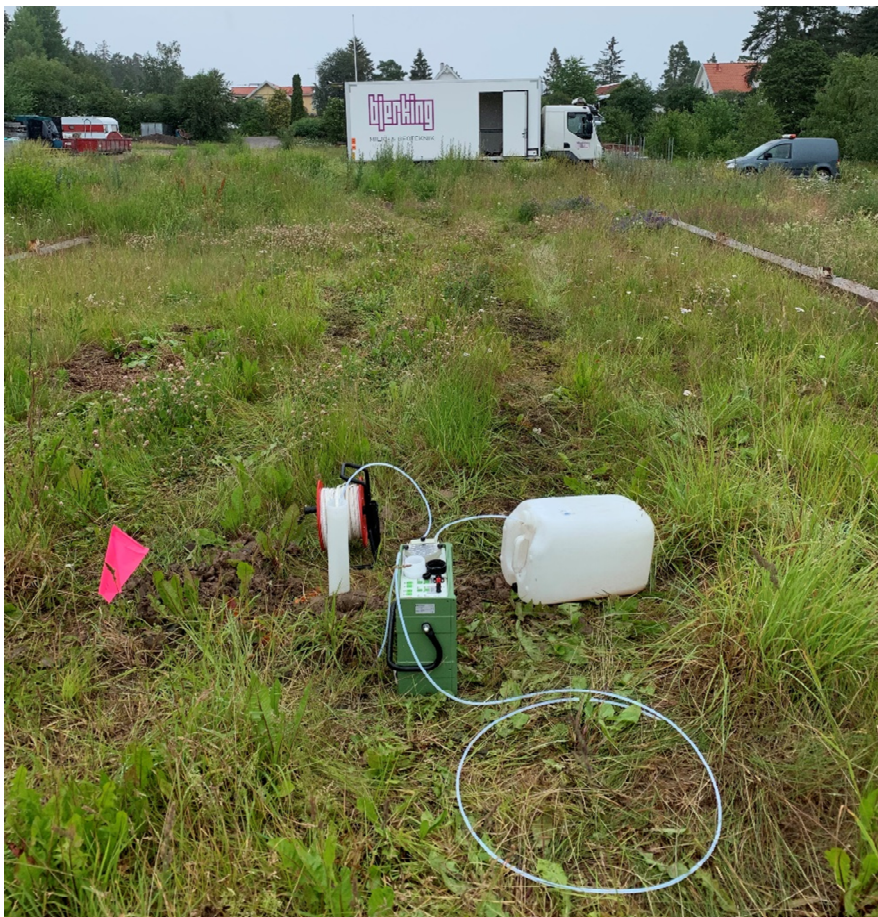
Figur 5 Omsättning av GV11 med en peristaltisk pump.
