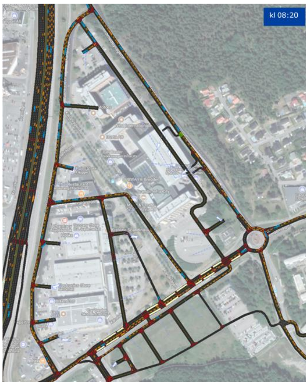
Figur 14 Ögonblicksbild från förmiddagens maxtimme i scenario 2040. Färgerna på fordonen motsvarar personbilar (orange) eller lastbilar (blå).
