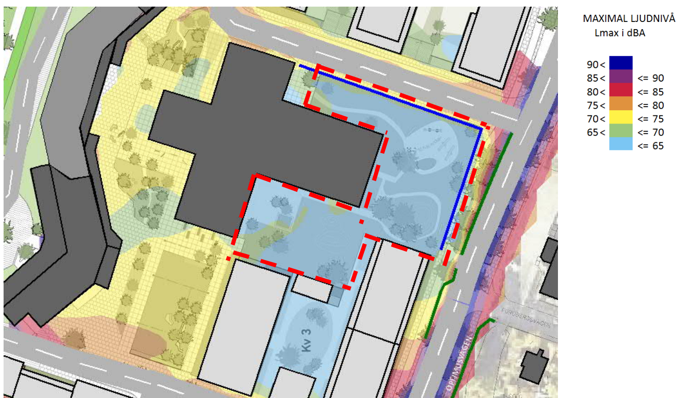
FIGUR 24. MAXIMAL LJUDNIVÅ 1,5 MÖM MED ÅTGÄRD 1,3 M HÖG MUR (GRÖN) VÄSTER OM OPTIMUSVÄGEN OCH EN 1,5 M GLASSKÄRM (BLÅ)
