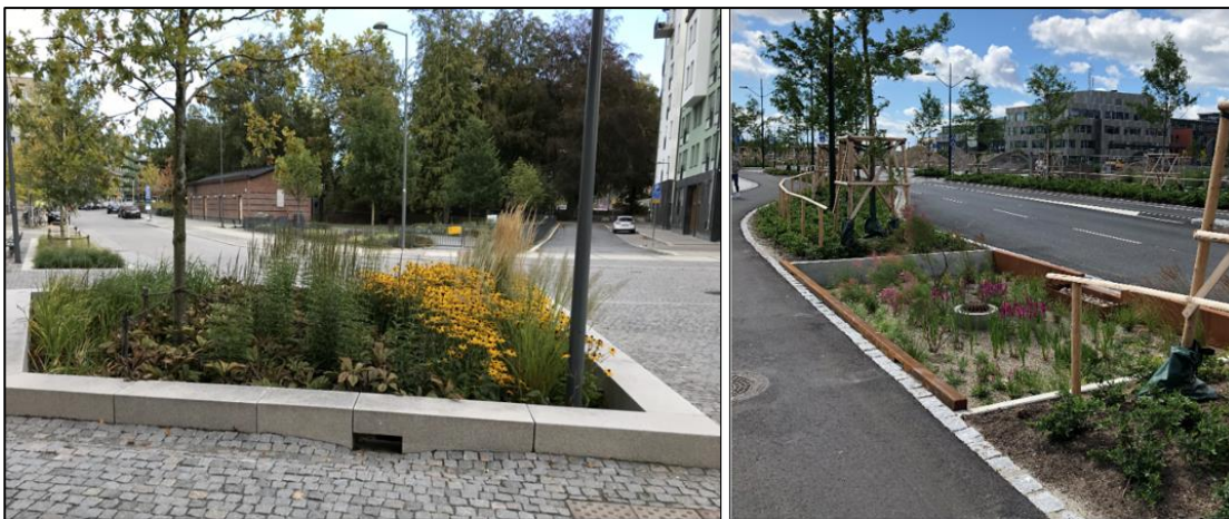
Figur 14. Exempel på nedsänkta regnbäddar (Foton: Norconsult)
