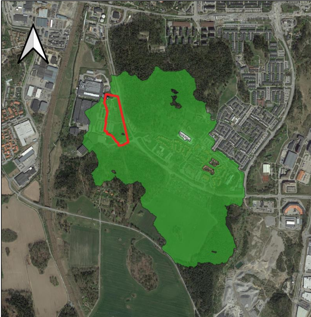
Figur 11. Avrinningsområde (grönt). Planområdet är markerat med röd linje. Analysen har utfört i Scalgo Live.
