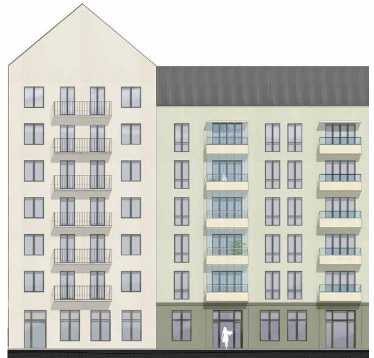
Inglasade balkonger mot spårområdet. Täta balkongräcken och skärmtak underlättar inglasning i senare skede. För ev. balkonger i gaveln förespråkas dock lättare räcken, t.ex. pinnräcken, för att hålla gavelmotivets gestaltning så ostörd som möjligt
