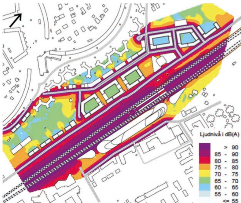
Figur 18. Maximal ljudnivå, 2 meter över marken (Sweco b, 2018).
